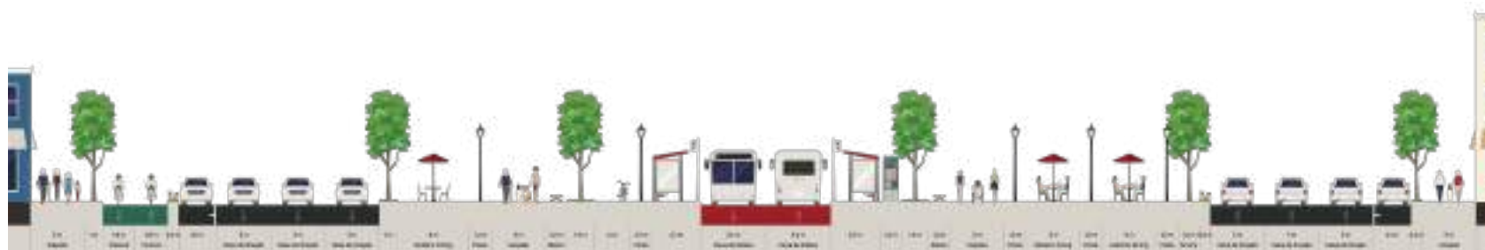
Figura 47 – Perfil transversal da proposta para a PA-275 (Trecho 7)
