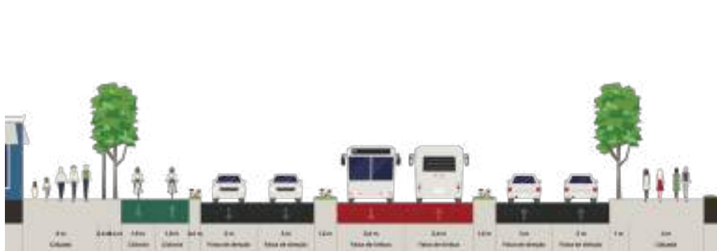
Figura 46 – Perfil transversal da proposta para a PA-275 (Trecho 6)
